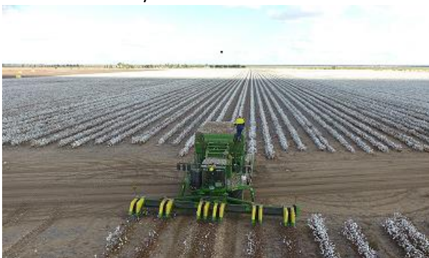
A baler stripper at Edgeroi.
