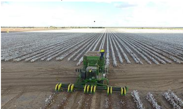
A baler stripper at Edgeroi.
